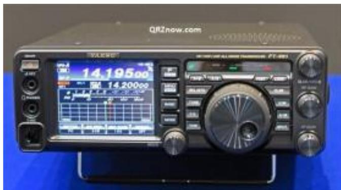
***La YAESU ha annunciato il lancio sul mercato di un nuovo ricetrasmittitore per le bande HF/50/144/430MHz. Il nuovo FT-991 può operare in SSB, CW, AM, FM, Packet e anche in digitale C4FM System Fusion.***
